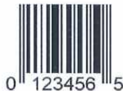
Hình 4 - Mã vạch UPC-E (mã hóa "0 123456 0000 5" bằng cách nén số 0)
